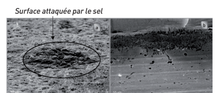
Micrographies MEB de l'alliage HR120 en présence de Na_2SO_4 après 96 h à 900°C sous gaz de synthèse. a) vue inclinée à 80° ; b) coupe transversale.
